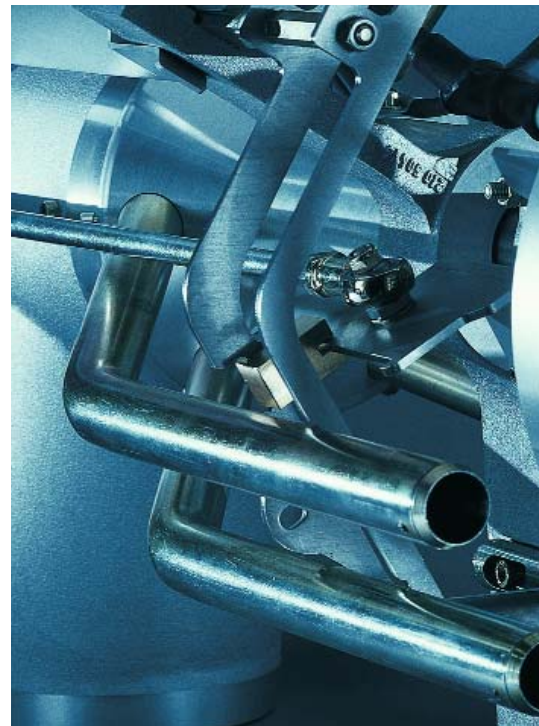
Mischeinrichtung des Weishaupt multiflam®-Gasbrenners. Diese
