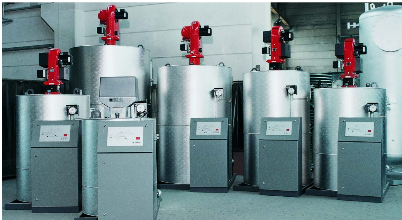
Die gasbefeuelten Wärmeträgererhitzer (80 kW bis 12 MW) der Firma HTT sind werkseitig komplett vormontierte Einheiten mit Schaltschrank, integrierter digitaler Steuerung und Weishaupt-Gasbrennern. Die maximale Betriebstemperatur geht bis 400 °C
